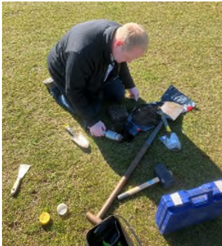
Figuur 2 Steken van ongestoorde kernen in de sportvelden op Ookmeer
